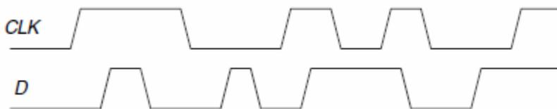
3.- Dada la siguiente entrada, dibujar la salida Q de un latch D, activado en nivel alto del reloj.
