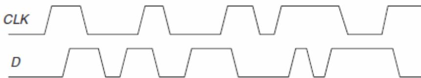
4.- Dada la entrada del ejercicio 2, dibujar la salida Q de un flip-flop D.
